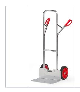
Ensemble mécano-soudé en aluminium. Soigneusement soudé sans revêtement, léger et maniable. Poignées de sécurité en plastique dur. Tablier cintré permettant d'embarquer des éléments ronds tels que rouleaux, bidons, seaux etc. Bavette en tôle d'alu à boulonner et remplaçable. Roues à bandage caoutchouc, moyeu à roulement à rouleaux. Livrée avec bavette démontée.
