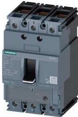
Leistungsschalter 3VA1 IEC Frame 160 Schaltvermögenklasse H Icu=70kA @ 415V 3-polig, Starterschutz TM120M, AM, In=50A ohne Überlastschutz Kurzschlusschutz Ii=7...16 x In Klemmenanschluss
