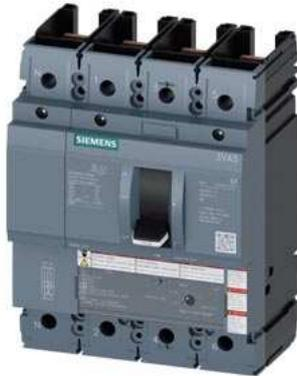
Leistungsschalter 3VA5 UL Frame 250 Schaltvermögenklasse M 35kA @ 480V 4-polig, Anlagenschutz TM210, FTFM, In=110A Überlastschutz Ir=110A fest eingestellt Kurzschlusschutz Ii=10 x In N-Leiter ungeschützt ohne Anschluss
