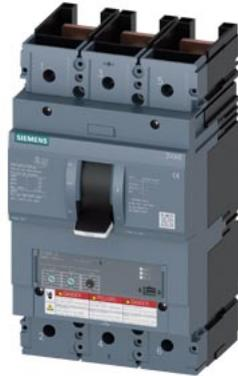
Leistungsschalter 3VA6 UL Frame 600 Schaltvermögenklasse C 100kA @ 480V 3-polig, Anlagenschutz ETU320, LI, In=400A Überlastschutz, 100% rated Ir=160A...400A Kurzschlusschutz Ii=1,5...12 x In ohne Anschluss
