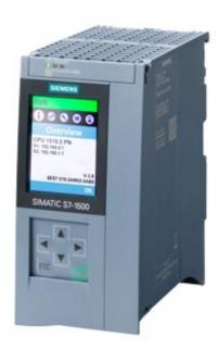
SIMATIC S7-1500, CPU 1515-2 PN, Zentralbaugruppe mit Arbeitsspeicher 500 KB für Programm und 3MByte für Daten, 1. Schnittstelle: PROFINET IRT mit 2 Port Switch, 2. Schnittstelle: PROFINET RT, 30 ns Bit-Performance, SIMATIC Memory Card notwendig
