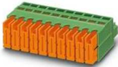
Leiterplattenstecker, Nennquerschnitt: 0,5 mm<sup>2</sup>, Farbe: grün, Nennstrom: 6 A, Bemessungsspannung (III/2): 200 V, Kontaktoberfläche: Zinn, Kontaktart: Buchse, Anzahl der Potenziale: 12, Anzahl der Reihen: 1, Polzahl: 12, Anzahl der Anschlüsse: 12, Artikelfamilie: QC 0,5/...-ST, Rastermaß: 3,81 mm, Anschlussart: Schneidanschluss, Anschlussrichtung Leiter/Platine: 0 °, Stecksystem: COMBICON MC 1,5, Verriegelung: ohne, Befestigungsart: ohne, Verpackungsart: verpackt im Karton
