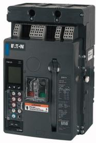
Leistungsschalter, 3-polig, 1600 A, 66 kA, Selektivschutz, IEC, Festeinbau
