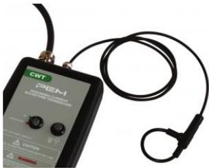
Die CWTMini50HF ist für schneller schaltende Anwendungen wie z.B. SiC optimiert und verfügt über eine Hochfrequenzbandbreite (-3 dB) von 50 MHz mit einer geschirmten 100-mm-Spule bei nur 3,5 mm Dicke (2 kV Spitzenisolierung).
