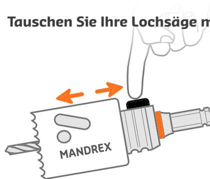
Um einen anderen Lochsäge-Durchmesser zu verwenden, drücken Sie die Taste und wechseln Sie die Lochsäge.
