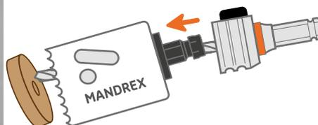
Drücken Sie einfach auf den Knopf und bewegen Sie die Lochsäge vor und zurück zum Lösen des Bohrkerns. Bohren Sie das nächste Loch einfach und schnell - ohne Mühe oder Wartezeit.
