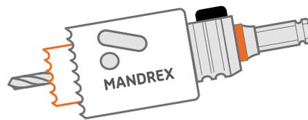
Ganz einfach! Jetzt können das kleinere Loch verwenden, um die Lochsäge zu zentrieren. Es ist einfach, ein Loch mit dem gewünschten Durchmesser zu bohren. Ein zusätzlicher Adapter ist erforderlich.
