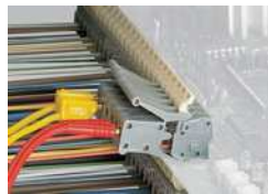
Prüfen mit Prüfsteckern
