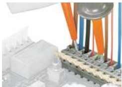
Prüfen mit Prüfspitzen
