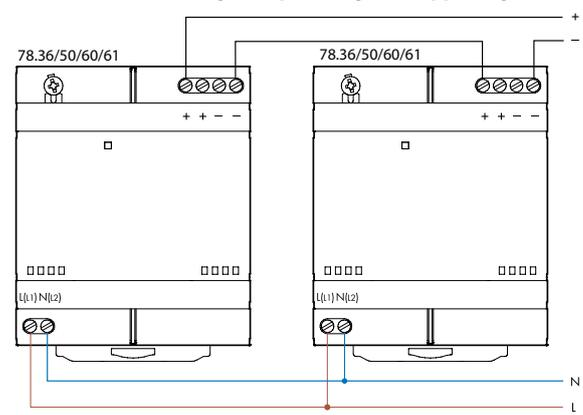
Parallelschaltung für erhöhten Strom (nur 78.50/60/61)
