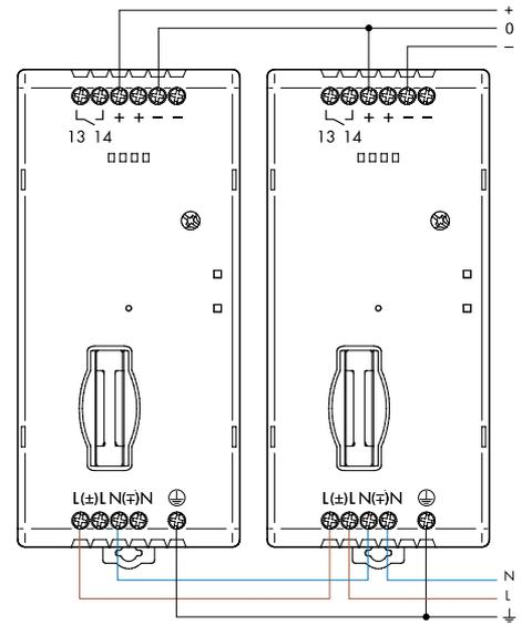
Parallelschaltung für erhöhten Strom
