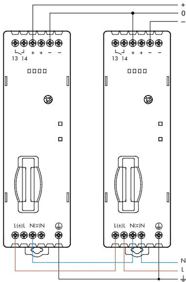
Parallelschaltung für erhöhten Strom
