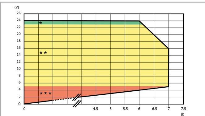
Fold-Back-Modus bei Umgebungstemperaturen bis zu 50 °C
