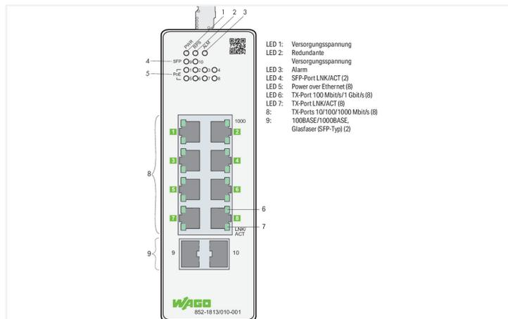
Der 852-1813/010-001 ist ein industrieller, konfigurierbarer ETHERNET-Switch mit 8 Ports 10/100/1000BASE-T, die alle „Power over Ethernet“ (PoE+) mit 30 W unterstützen und 2 Ports SFP 100BASE-FX/1000BASE-LX/SX/ZX (SFP-Module sind optional erhältlich).
