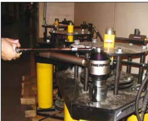
◀ Der Enerpac Reaktionsstangen Drehmomentvervielfacher E393 wird für manuelles Schraubenanziehen bis zu 4300 Nm eingesetzt.
