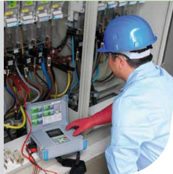
**MicroOhm MI 3250 ist ein tragbares Messgerät für die Niederohmmessung mit einem Prüfstrom bis zu 10 A für z.B Leistungsschalter, Schalter, Stromschienen, Kabelverbindungen, Transformator und Motorwicklungen.**
