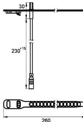
Einsteck-Temperaturfühler für den Einsatz bei A3000 open Armaturen zur Erfassung von Temperaturen mit PT1000 Messelement.
