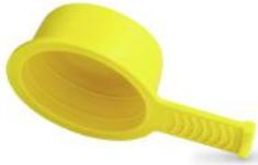
Der flexible Kegelschloss mit seitlicher Lasche GPN 609 ist universell einsetzbar als Kappe oder Stopfen und schützt Bohrungen und Innengewinde und Bolzen und Außengewinde. Die Griffflasche mit geschütztem Laschendesign ermöglicht eine sehr schnelle Montage und Demontage. Die Konizität eignet sich bestens zur Überbrückung von Toleranzen. Das Material ist hitzebeständig bis zu 150° C.
