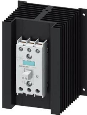
Halbleiterschütz 3-phasig 3RF2 AC 51 / 50 A / 40 °C 48-600 V / DC 4-30 V 3-Phasengesteuert Schraubanschluss Sperrspannung 1200 V
