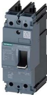
Leistungsschalter 3VA5 UL Frame 125 Schaltvermögenklasse M 35kA @ 480V 2-polig, Anlagenschutz TM210, FTFM, In=35A Überlastschutz Ir=35A fest eingestellt Kurzschlusschutz Ii=10 x In UL 489 SB (Naval), 50° C ohne Anschluss
