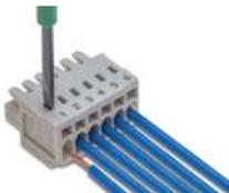
Leiter anschließen – Betätigung des CAGE CLAMP®-Anschlusses mit Schraubendreher (2,5 x 0,4) mm – rechtwinklig zur Leiteranschlussrichtung.
