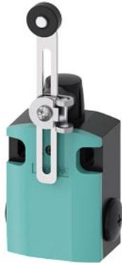
Positionsschalter Metallgehäuse 56 mm breit Geräteanschluss 3x (M20x 1,5) 1S/1Ö Schleikontakte Schwenkantrieb rechts/links einstellbar, mit längenverstellbarem Metallhebel 100 mm lang und Kunststoffrolle 19 mm
