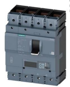
Leistungsschalter 3VA2 IEC Frame 400 Schaltvermögenklasse H Icu=85kA @ 415V 4-polig, Anlagenschutz ETU850, LSI, In=250A Überlastschutz Ir=100A...250A Kurzschlussschutz Isd=0,6..10x In, Ii=1,5..12x In N-Leiterschutz einstellbar (OFF, bis 160%) Schraubenflachanschluss
