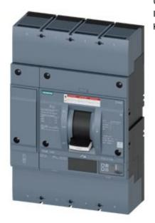
Leistungsschalter 3VA6 UL Frame 1000 Schaltvermögenklasse C 100kA @ 480 V 4-polig, Anlagenschutz ETU550, LSI, In=1000A Überlastschutz Ir=400A ...1000A Kurzschlussschutz Isd=0,6..10x In, Ii=1,5..10x In N-Leiterschutz einstellbar (OFF, bis 160%) beidseitig Kabelanschluss
