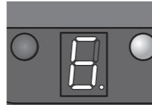
Premere il tasto sul retro finché sul display viene visualizzata la durata di esercizio automatico desiderata. Il simulatore TV si accende automaticamente appena si fa buio (intensità luminosa <30 lux).
