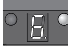
Pulse repetidamente la tecla en la parte trasera hasta que la pantalla visualice el período deseado para el funcionamiento automático. Su simulador de televisión se enciende automáticamente cuando oscurece (intensidad de la iluminación <30 lux).
