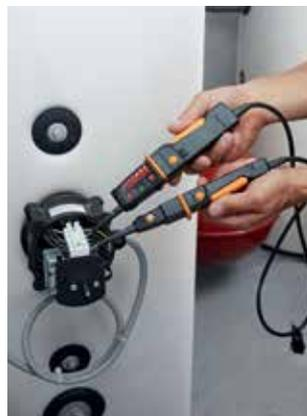
Spannungsmessung an einem Heizlastspeicher.
