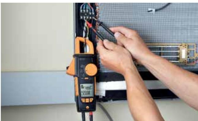
Spannungsmessung an einem Klimagerät mit **testo 770**.
