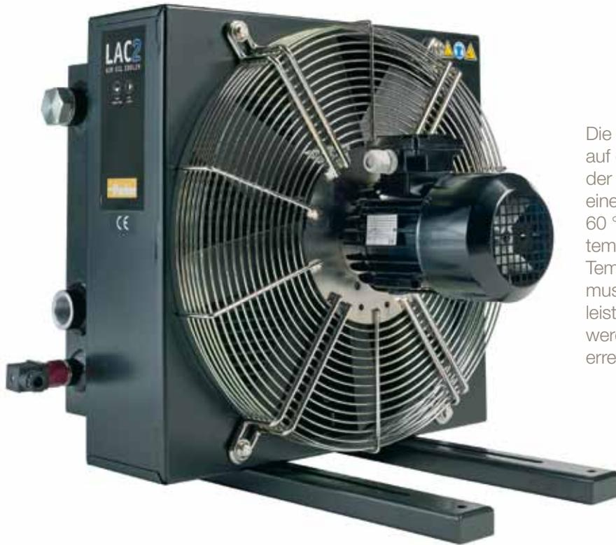
Die Kühlleistungskurven basieren auf der Öleintrittstemperatur und der Umgebungstemperatur. Bei einer Öleintrittstemperatur von 60 °C und einer Umgebungstemperatur von 20 °C beträgt die Temperaturdifferenz 40 °C. Diese muss mit der spezifischen Kühlleistung in kW/ °C multipliziert werden, um die Kühlleistung zu errechnen.
