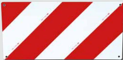
Warntafel für überbreite und überlange Fahrzeuge, 564 x 282 mm, aus Aluminium, mit 4 Befestigungsbohrungen, Vorderseite Reflexfolie RA1,A, rot/weiß
