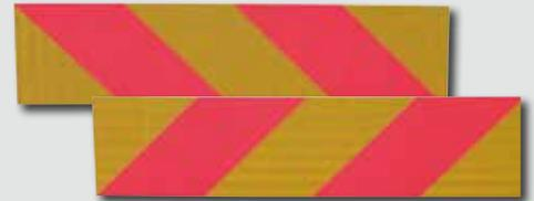
Heckmarkierungen nach ECE 70, aus Aluminium 1,5 mm stark, bauartgeprüft, zweiseitig 10 mm abgekantet, mit Befestigungszubehör, Vorderseite Reflexfolie RA2,B gelb mit tagesleuchtender roter Folie
