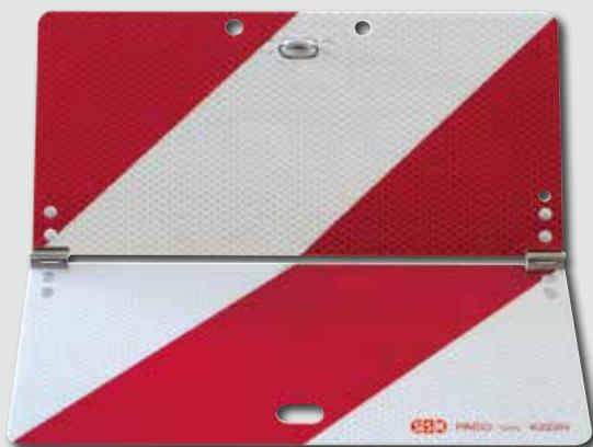
Nachtparktafel Typ 3 - **bauartgeprüft, klappbar**, 285 x 285 mm, aus **Aluminium**, Vorderseite **Hochreflexfolie RA3,C**, rot/weiß, Scharniere und Drehverschluss aus **Edelstahl**
