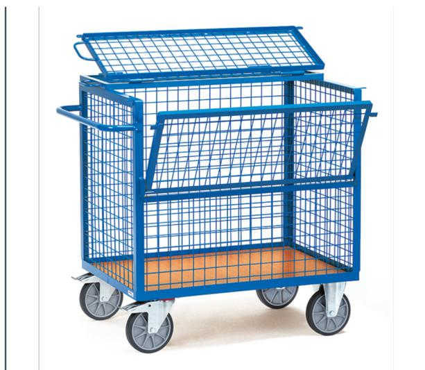
Ensemble mécano-soudé, revêtement époxy bleu RAL 5007. Habillage en treillis métallique 50 x 50 x 4 mm avec plateau en mélaminé surface effet hêtre. Couvercle à double battant et anneau pour cadenas. 2 roues pivotantes et 2 roues fixes à bandage TPE, moyeu à roulement à billes central. Freins sur roues pivotantes conformément à la Norme Européenne 1757-3 (Sécurité des chariots de manutention).
