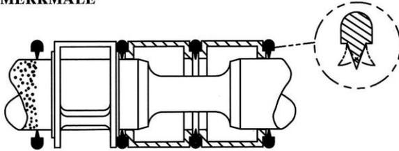
**TAPERED TEE SEAL ® STEHT FUER ZUVERLAESSIGKEIT**
