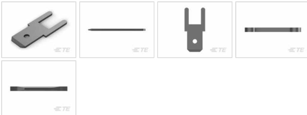
Leiterplatten – Klemmentyp: **Flachstecker**Leiterplattendicke (empfohlen): **3.63 – 4.45 mm [ .143 – .175 in ]**Flachkontaktbreite: **4.75 mm [ .187 in ]**Flachkontaktdicke: **.81 mm [ .032 in ]**Leiterplatten-Bohrungsdurchmesser: **1.4 mm [ .055 in ]**
