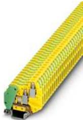
Schutzleiter-Reihenklemme, Bei Anreihung an konturgleiche Durchgangsklemme muss bei Isolationsspannungen > 320 V ein Deckel eingesetzt werden, Anzahl der Anschlüsse: 3, Anschlussart: Schraubanschluss, 1. Etage, Querschnitt: 0,14 mm<sup>2</sup> - 1,5 mm<sup>2</sup>, Montageart: NS 15, Farbe: grün-gelb
