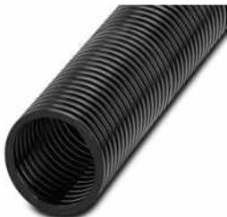
Schutzschlauch, Material: PA 6, UV-beständig: ja, flexibel, Schutzart: IP68, Farbe: schwarz, Brennbarkeitsklasse nach UL 94: HB, Innendurchmesser: 36 mm, Gesamtlänge: 25 m
