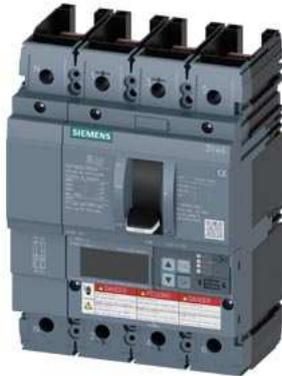
Leistungsschalter 3VA6 UL Frame 250 Schaltvermögenklasse L 150kA @ 480V 4-polig, Anlagenschutz ETU820, LI, In=100A Überlastschutz, 100% rated Ir=40A...100A Kurzschlusschutz Ii=1,5...12 x In ohne Anschluss
