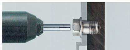
3. Zugstift mit Nietsetzgerät GESIPA PowerBird® Pro vollständig abziehen (Mundstück 17/ 36 oder 17/40 verwenden)
