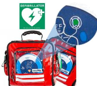
Die Einsatzbereitschaft (grün blinkende LED), das MHD der Batterie- und Elektrodenkassette und das Datum der nächstfälligen STK-Prüfung sind problemlos ablesbar.
