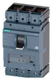
LEISTUNGSSCHALTER 3VA2 IEC FRAME 630 SCHALTVERMOEGENKLASSE C ICU=110KA @ 415 V 3-POLIG, ANLAGENSCHUTZ ETU350, LSI, IN=400A UEBERLASTSCHUTZ IR=160A ...400A KURZSCHLUSSSCHUTZ ISD=1,5... 10 X IR, II=12 X IN SCHRAUBENFLACHANSCHLUSS
