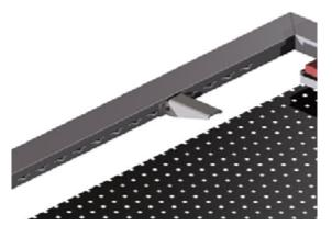
Dieser hier gezeigte Blechwinkel dient den aufgeschraubten Siebdruckplatten als Stützte. Die entsprechend ausgerüsteten Rahmenprofile müssen so herum eingebaut werden, dass die geschlossene Seite des Winkels nach Oben zeigt.
