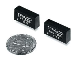
Die TMA-Serie bietet ultrakleine, isolierte 1 W DC/DC-Konverter im SIL-Gehäuse. Aufgrund des kleinen Platzbedarfs von nur 1.2 cm² sind sie die ideale Lösung für eine Vielzahl platzkritische Anwendungen auf der Printkartenebene. Dank des Aufbaus in SMD-Technologie sind diese Konverter sehr zuverlässig und kostengünstig.
