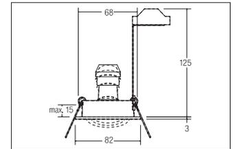
Hochvolt-Einbaustrahler, GU10, weiß. Ausgeführt in kompakter Bauform für werkzeuglose Schnellmontage zum Deckeneinbau. Inkl. Hochvoltbügel zur normgerechten Zugentlastung. Fassung: GU10, Montageart: Einbaumontage, Montageort: Deckenmontage, Material: Aluminium, Schutzart: nach DIN EN 60529: IP20, Schutzklasse: (EN 61140) II, Spannung: 230V AC 50Hz, Leistung: max. 50W, Anzahl der Leuchtmittel / Fassungen: 1.0 Stk, Verstellbarkeit: schwenkbar, ohne Betriebsgerät, Art der Dimmung: sonstige.
