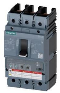
Leistungsschalter 3VA6 UL Frame 150 Schaltvermögenklasse H 65kA @ 480V 3-polig, Anlagenschutz ETU330, LIG, In=40A Überlastschutz Ir=16A...40A Kurzschlussschutz Ii=1,5...12 x In Erdschlussschutz Ig=0,375...1 x In, tg=0,1/0,3s ohne Anschluss
