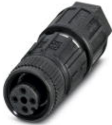
Sensor-/Aktor-Steckverbinder, Buchse, gerade, 4-polig, M12, A-kodiert, QUICKON-ONE, Kunststoffrändel, Kabeldurchmesser max. 6 mm
