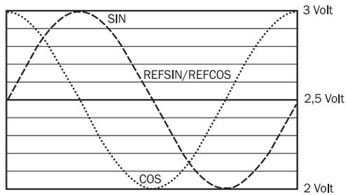
Signalverlauf bei Drehen der Welle im Uhrzeigersinn mit Blick in Richtung "A" (siehe Maßzeichnung) 1 Periode =  $360^\circ : 1024$
