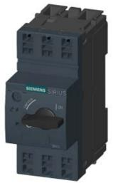
CIRCUIT-BREAKER SZ S00, FOR MOTOR PROTECTION, CLASS 10, A-RELEASE 0.11...0.16A, N-RELEASE2.1A SPRING-L. CONNECTION STANDARD SW. CAPACITY
