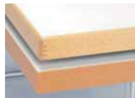
Umleimer · Buche Massivholz, 65 mm hoch, fingerverzinkt, abgerundet, gebeizt und mit DD-Lack versiegelt · Alternativ: 2 mm ABS-Umleimer im Plattendekor, 65 mm hoch
