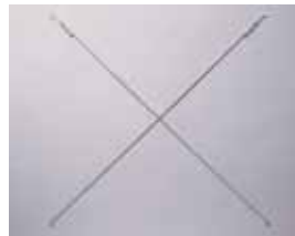
Kreuzdiagonale. Zur sicheren Verstrebung für Steckregale, die überwiegend einseitig genutzt werden und deshalb nicht mit Breitenriegeln ausgestattet werden müssen.
