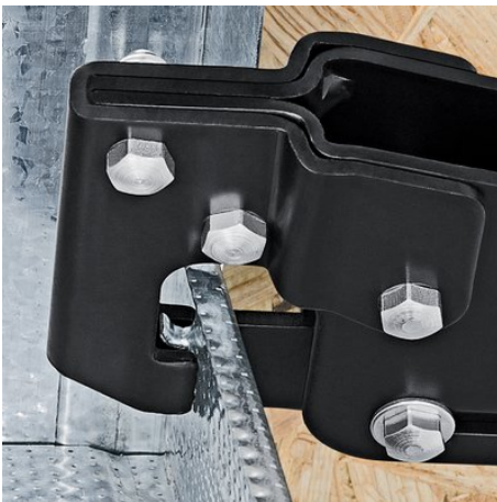
Das Stempelwerkzeug wird durch die Profilbleche gedrückt
