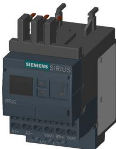
UEBERWACHUNGSRELAIS ANBAUBAR AN SCHUETZ 3RT2, BAUGROESSE S00 STANDARD, DIGITAL EINSTELLBAR SCHEIN-/WIRKSTROMUEBERWACHUNG 1,6 - 16A, 20-400 HZ, 3-PHASIG VERSORGUNG 24 V AC/DC 1 WECHSLER, 1 HALBLEITERAUSGANG FUER ALARM UND WARNUNG UEBERWACHUNG AUF STROMUEBER- U. UNTERSCHREITUNG PHASENAUSFALL, DRAHTBRUCH PHASENFOLGE FEHLERSTROM BLOCKIERSTROM WARNUNG UND ALARMSCHWELLEN MIT ODER OHNE FEHLERSPEICHER ANLAUFVERZOEGERUNG 0-99 S STOERSPITZEN AUSBLEND. 0-30 S PAUSE NACH FEHLER 0-300 MIN FEDERZUGTECHNIK
