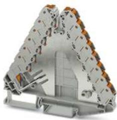
Potenzialverteiler, mit Einspeisemöglichkeit bis zu 6 mm<sup>2</sup>, Nennspannung: 250 V, Nennstrom: 17,5 A, Anschlussart: Push-in-Anschluss, Bemessungsquerschnitt: 1,5 mm<sup>2</sup>, Querschnitt: 0,14 mm<sup>2</sup> - 2,5 mm<sup>2</sup>, Einspeisetage, Bemessungsquerschnitt: 4 mm<sup>2</sup>, Querschnitt: 0,2 mm<sup>2</sup> - 6 mm<sup>2</sup>, Montage: NS 35/7,5, NS 35/15, Farbe: grau, Farbe Anschlusselemente: braun
