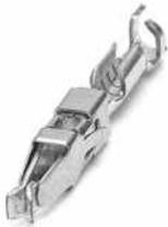
Buchsenkontakt, wird nach dem Antrimpen des Leiters in das Steckerteil geschoben, für die Modulsteckergehäuse MCC 1/...-STZ-3,81 und MCC 1/...-STZF-3,81, für Querschnittsbereiche von 0,2 mm<sup>2</sup> bis 0,34 mm<sup>2</sup>
