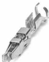
Buchsenkontakt, wird nach dem Ankrimpen des Leiters in das Steckerteil geschoben, für die Modulsteckergehäuse MCC 1...-STZ-3,81 und MCC 1...-STZF-3,81, für Querschnittsbereiche von  $0,5 \text{ mm}^2$  bis  $1 \text{ mm}^2$
