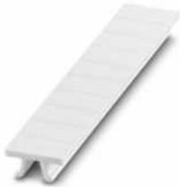
Zackband, Streifen, weiß, unbeschriftet, beschriftbar mit: PLOTMARK, CMS-P1-PLOTTER, Montageart: verrasten, für Klemmenbreite: 5,2 mm, Schriftfeldgröße: 5,1 x 10,5 mm, Anzahl der Einzelschilder: 10
