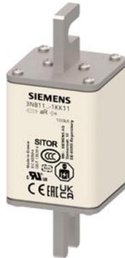
SITOR-Sicherungseinsatz Baugröße 1 500A aR 600V dc/750V VSI 700V dc UL
