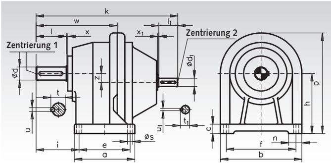
Die Wellenenden  $\varnothing d$  sind nach ISO k6 bearbeitet.
